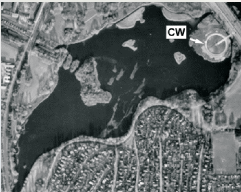
Sistema di depurazione naturale a flusso verticale subsuperficiale per il trattamento dello sfioratore fognario del lago Utterslev (Copenaghen).
